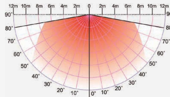
**!** Doporučená montáž je 1 až 1,5 metru nad podlahu tam, kde činnost čidla nebude ovlivněna přímým prouděním vzduchu, slunečním zářením a dalšími rušivými vlivy (zahrnutí závěsu, stažení žaluzií, zastavení nábytkem atd.). **Dosah infrapasivního snímače je závislý také na rychlosti pohybu a teplotě okolí, čidlo instalujte min. 1,5 metru od zdrojů tepla (svítidla, topná tělesa).**
