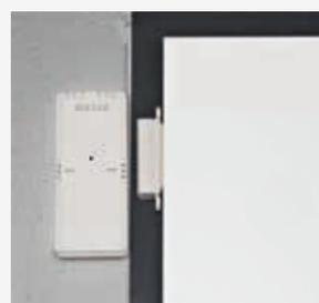
Při změně stavu kontaktů (zavření nebo otevření dveří, okna) dojde k vyslání signálu do přijímače, který sepne připojené zařízení nebo vydá zvukový signál. Lze volit mezi dvěma četnostmi vysílání. Rychlá (cca 3 sekundy) - v případě hlídání, zda někdo vešel do dveří, nebo s prodlevou (5 minut), v případě ovládání např. oběhového čerpadla TUV.
