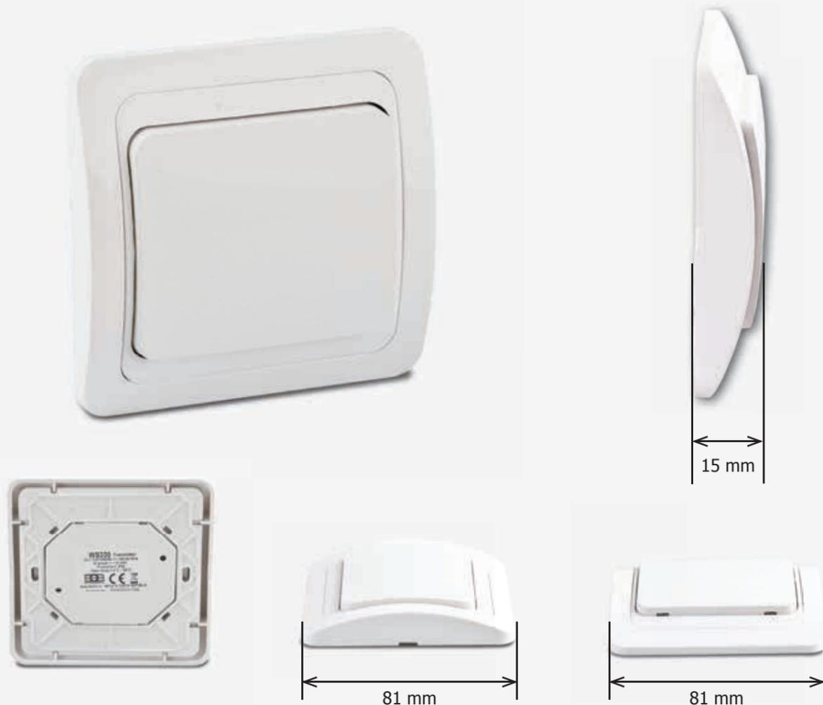
**i** Vysílač na stěnu má v každém rohu hmatníku zabudovaný jeden spínač - celkem tedy čtyři kanály. Po stisknutí je vyslán kódovaný signál pro spárovaný přijímač, který provede naučenou funkci. Každý kanál může mít jinou funkci a může ovládat i několik přijímačů najednou nebo ovládat různé funkce přijímače (zapnout / vypnout osvětlení, ovládat žaluzie, elektrické zámky apod.).
